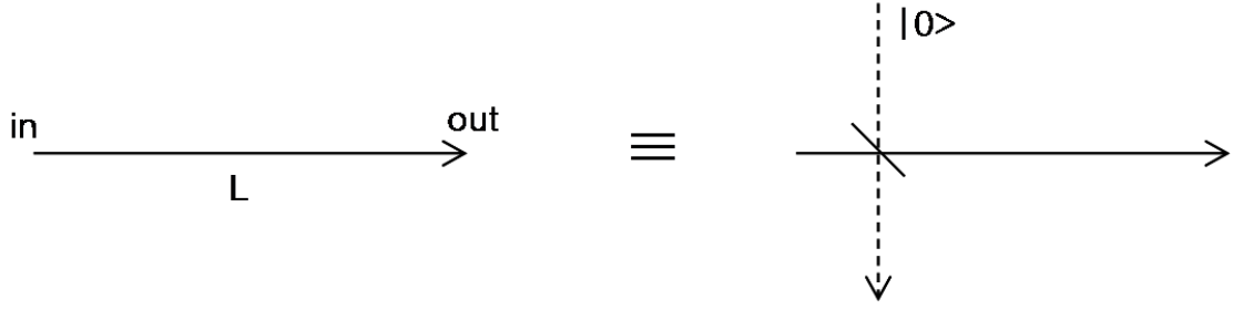
FIG. 3.2 – Equivalence entre un canal à pertes et un canal parfait précédé d'un diviseur de faisceau.
