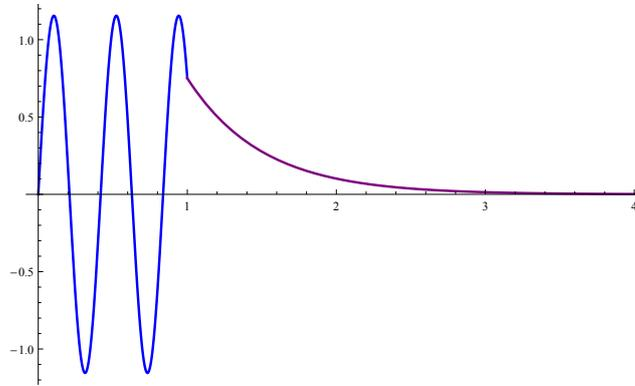
À l'intérieur du puits, on a une fonction sinusoïdale et à l'extérieur, une exponentielle qui décroît. Ainsi, contrairement au cas classique, il y a une probabilité non nulle de se trouver à l'extérieur du puits. Toutefois, cette probabilité diminue quand on s'éloigne du puits.
